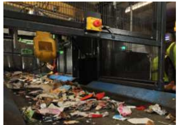
< 말러스크에 설치된 리사이클아이 로봇 >
